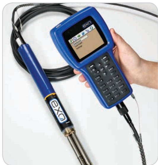
EXOハンディディスプレイとEXOモニターのフィールドケーブル接続
